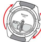
Girar el reloj más de una vuelta completa sobre una superficie horizontal (p. ej., una mesa) en un lugar en el que no existan perturbaciones magnéticas imprimiendo una velocidad de giro de alrededor de 30° por segundo.
