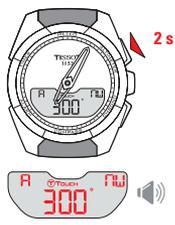
Modo de ajuste de la dirección acimutal
