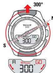
c) El eje 6 h-12 h está alineado con la dirección acimutal
