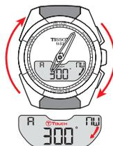
a) Gire hacia la derecha el eje 6 h-12 h para alinear las 12 h con la dirección acimutal
